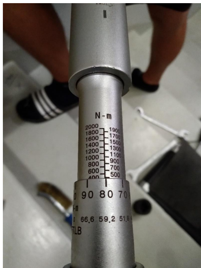
Fot. 2 – Klucz dynamometryczny JONNESWAY T272000N. Moment 480 Nm.
