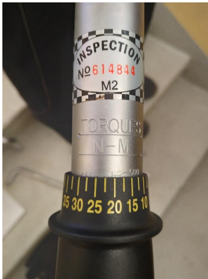
Fot. 1 – Klucz dynamometryczny YATO YT-0770. Moment 480 Nm.
